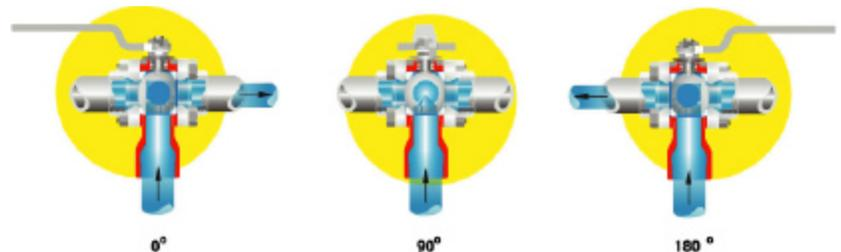
**PORTING 3.** Operación a 180°, sin posición de cerrado con conexión a cada uno de los puertos o a los dos.
